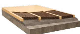
LLENADO COMPLETO DE LA CÁMARA DEL PISO
