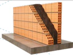
LLENADO PARA LAS DOBLES PAREDES INTERIORES CON GRANULADO
