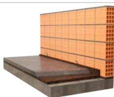
DESACOPLAMIENTO DEL MORTERO DE RELLENO A LA PARED
