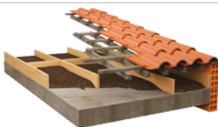
LLENADO DE CÁMARAS SOBRE LOSA
