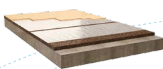
SUELO RADIANTE ELECTRICO
