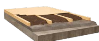
LLENADO DE LA CÁMARA DEL PISO
